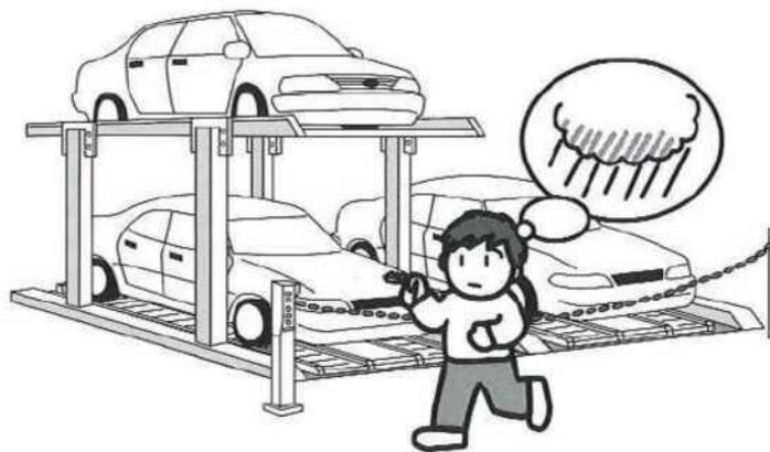
ピットには排水設備が設けてありますが、**異常降雨などで周りから排水能力を上回るような水が流れ込む**と、ピットの冠水により、クルマや装置に損害を与える恐れや、感電の危険があります。
